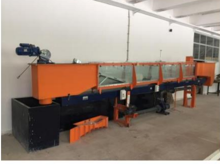
Resim 1: Çeşitli Boyutlarda Eğim Verilebilen Akım Kanalları
